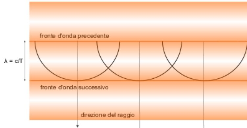
Ciascun punto di un fronte d'onda è sorgente di un fronte d'onda sferico. L'onda ad un tempo successivo è la somma di questi nuovi fronti d'onda.
